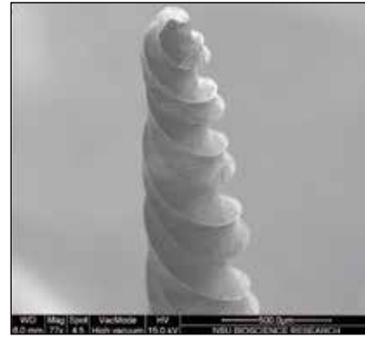
Fig. 3 y 4. Características del Diseño de WOG. Sección transversal en forma de paralelogramo que le da un aspecto asimétrico.
