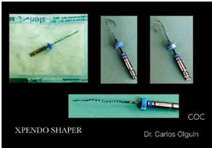
En esta imagen se observa la deformación permanente del metal después de ser re-esterilizado y re-utilizado.
