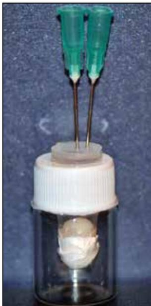
**Figura 6.** Dispositivo diseñado para el modelo de filtración bacteriana. Cámara superior, donde se ubica la porción radicular del diente y la cámara inferior, donde se ubica la porción coronaria. Las uniones se encuentran selladas, siendo las agujas el único medio de comunicación con el exterior.
